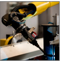
Автоматизированная сварка роботом
